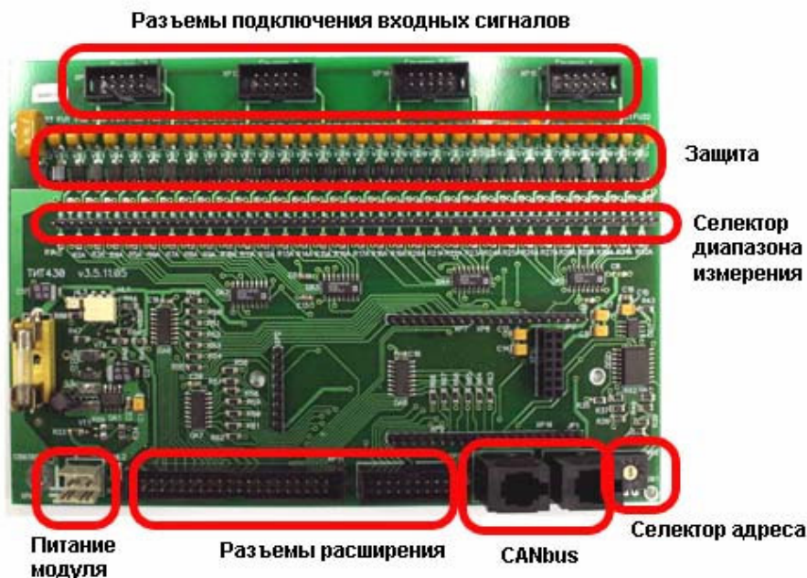
Рисунок 12. Соединительная плата ТИТ430 – основные элементы
